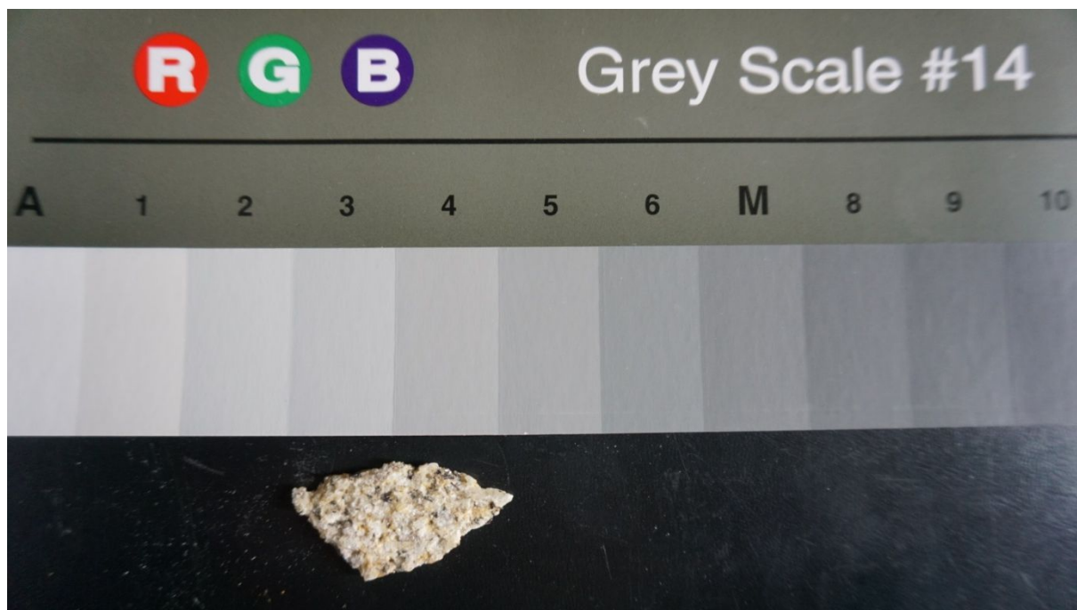
Vzorek vydroleného žulového schodu.
